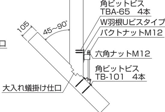
※斜め梁(平面)に使用する場合には、材断面を105mm×105mm以上としてください。
