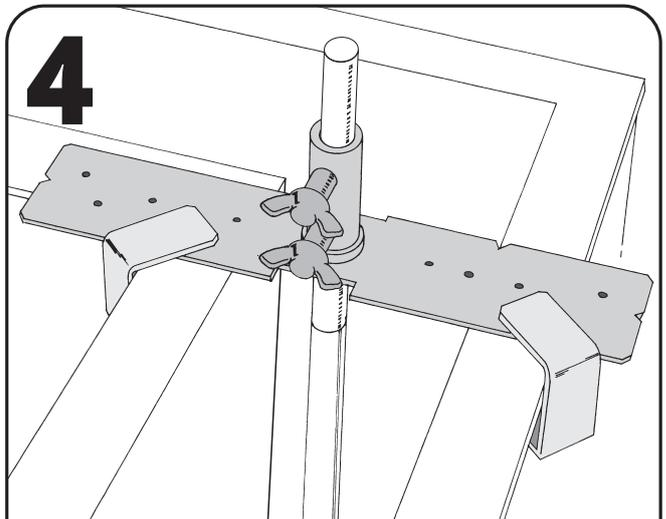
④埋め込み長さによりアンカーボルトの上下位置を決めて、蝶ボルトでしっかりと固定してください
