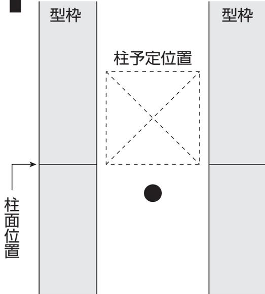
①アンカーボルトの施工位置を決めてください。（ホールダウン専用アンカーボルトの位置を決める場合は柱面の位置を決めると便利です）
