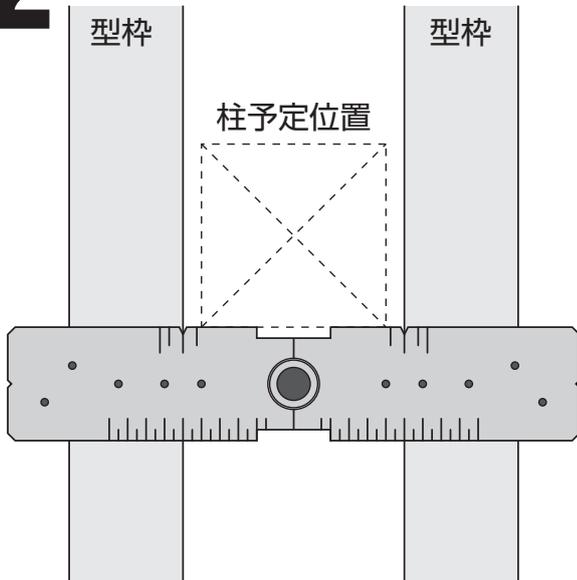
②基礎の中にあわせてM式アンカーセパを設置してください。（アンカーボルトの位置が基礎の中心からずれている場合は刻印を参考にして設置してください）
